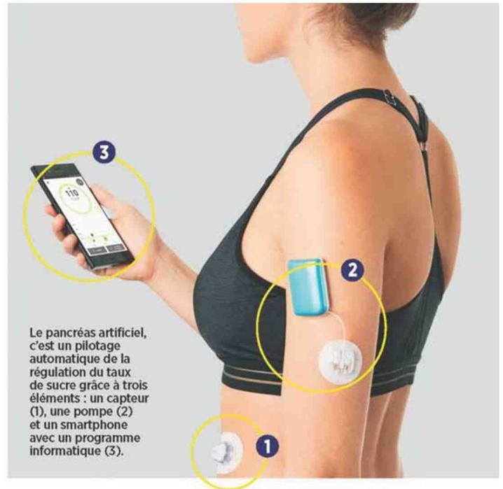
Le pancréas artificiel, c'est un pilotage automatique de la régulation du taux de sucre grâce à trois éléments : un capteur (1), une pompe (2) et un smartphone avec un programme informatique (3).
